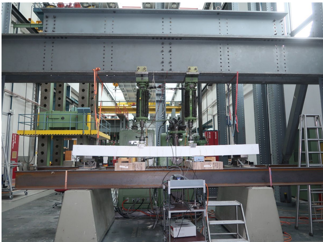
Abb. 7.20 Die gesamte Versuchseinrichtung der Ermüdungsversuche von vorne. Platte 5 unter statischer Belastung.
