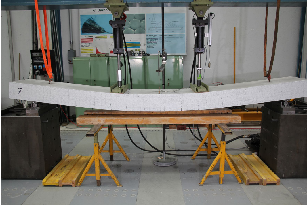
Abb. 7.44 Frontansicht Platte 7 am Ende des Versuches.
