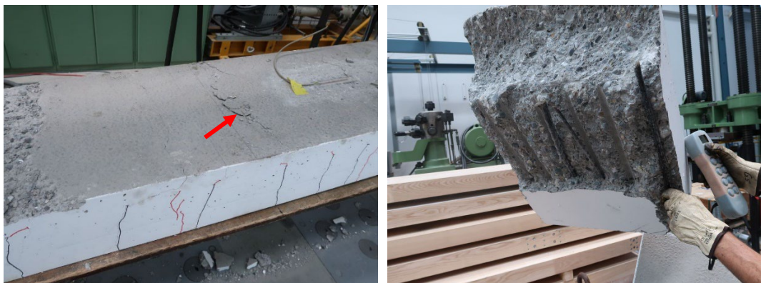
Abb. 7.63 Links: Platte 5, Betonstauchen sichtbar (roter Pfeil). Rechts: Platte 5, Bruch der Basaltfaser-Bewehrung an der Stelle des letzten Schubrisses.
