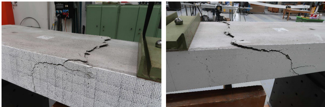
Abb. 7.31 Links: Detailfoto des Schubbruches in Platte 6. Rechts: Detailfoto des Schubbruches an der Rückseite der Platte.
