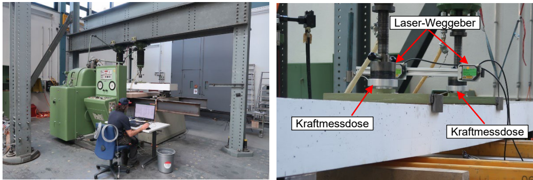
Abb. 7.19 Links: Versuchseinrichtung der Ermüdungsversuche von hinten. Der linke grüne Kasten ist der Pulsator, der rechte grüne Kasten ist das Steuerpult. Rechts: Kraftmessdosen zur Kraftmessung und Laser-Weggeber in Balkenmitte.
