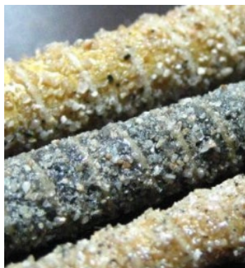
Abb. 3.6 Verschiedene Oberflächenstrukturen von Basaltfaser-Bewehrungen auf dem Markt.
