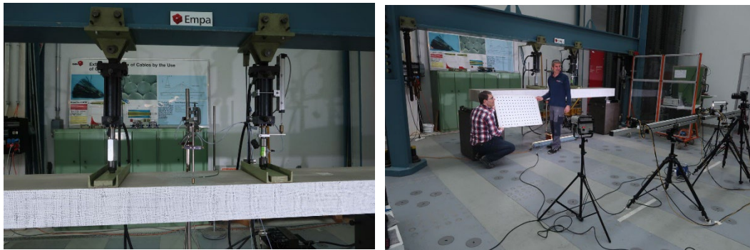
Abb. 7.16 Links: Prüfzylinder mit Stahlteilen zur Kraftverteilung, Kraftmessdose unter rechtem Prüfzylinder, Weggeber in Plattenmitte. Rechts: Kalibration eines Messfeldes für die Bildkorrelationsmessungen.
