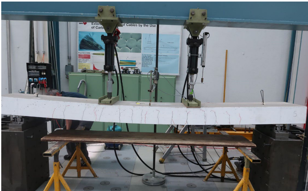
Abb. 7.59 Frontansicht Platte 5 während des statischen Bruchversuches.
